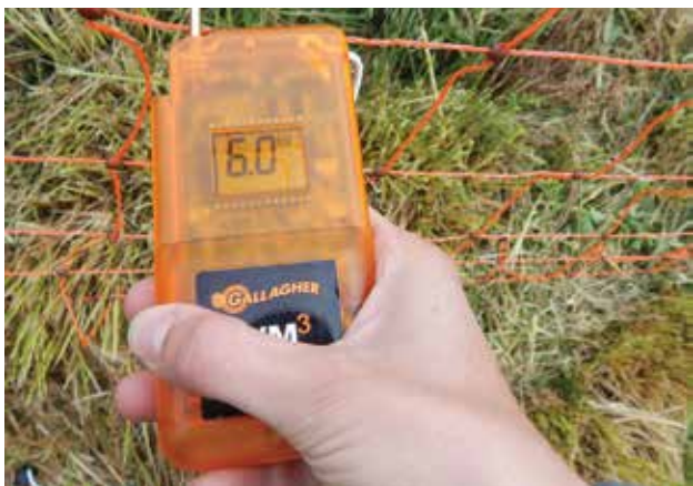
Napetost v elektromrežah merimo s pomočjo voltmetra (Foto: Mateja Berce)
