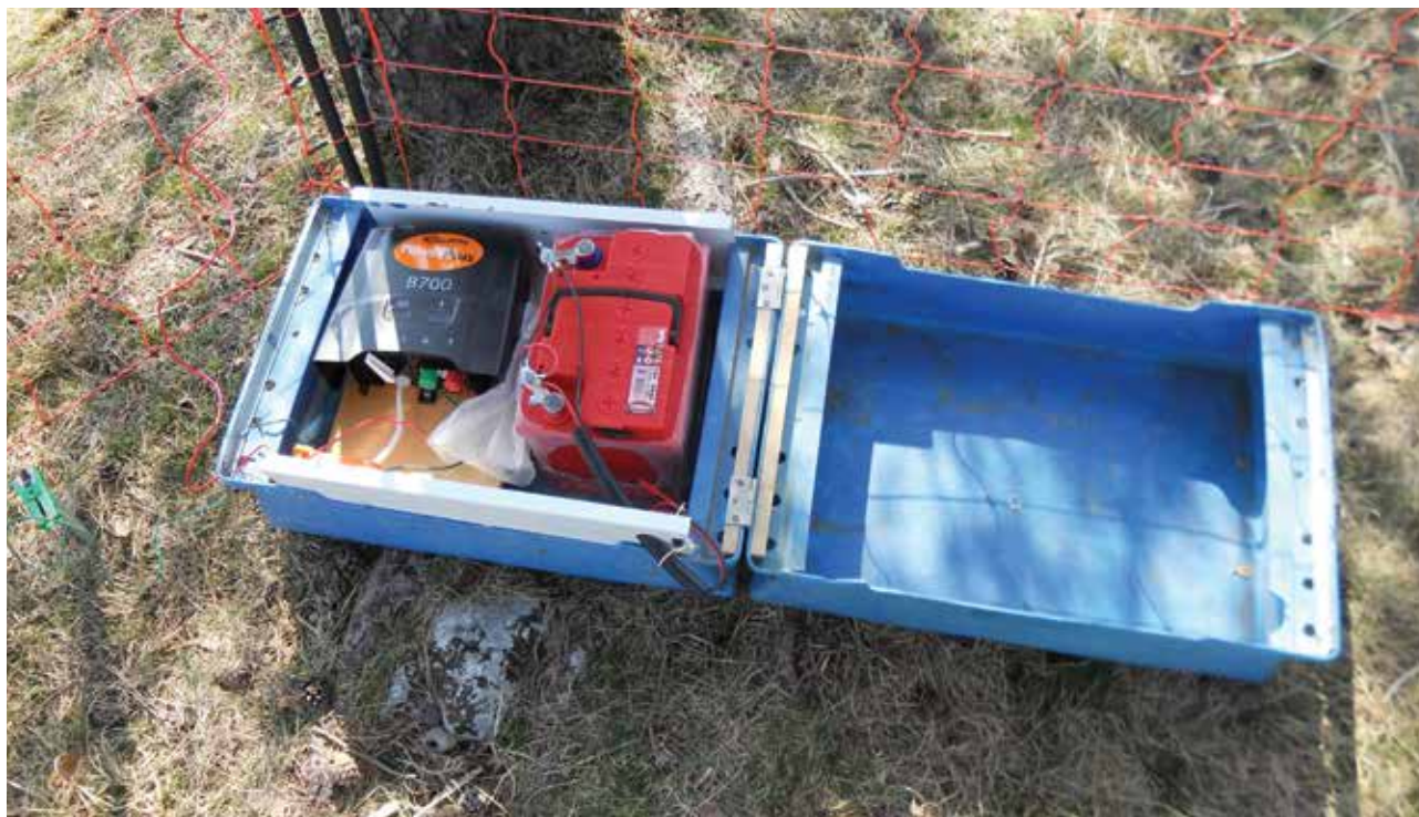
Pašni aparat in akumulator namestimo v škatlo, ki ju ščiti pred vremenskimi vplivi (Foto: Rok Černe)
